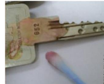
TESTS DE DÉTECTION : Nickel Spot Test détecte taux de 10ppm, Chémo Nickel Test (sel insoluble rose), Papiers réactifs (Macherey-Nagel) : Fer, Nickel, Cuivre, Plomb
